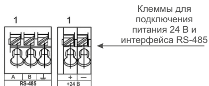
Рисунок 2 - Схема подключения к клеммам при снятой крышке корпуса
